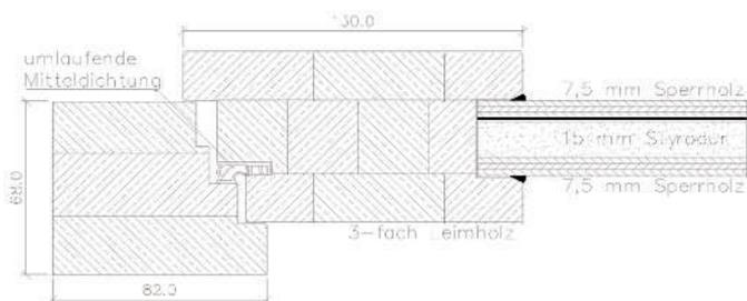
Rahmen aus 3-fach Leimholz 68 x 130 mm stark mit umlaufender Mitteldichtung, Sockelhöhe 130 mm, Füllung 30 mm, Mittellage 15 mm Styrodur und Dampfsperre, Innen + außen 7,5 mm Sperrholz und modellabhängig, 7,5 mm Aufdopplung in Profildesign-Optik, PZ-Schloss Dom 55 mm, Abstand 92 mm, Nuss 10 mm und 2x 2D-Lappenbänder montiert.
